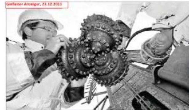
Mit Industriemaschinen besitzt ist der Bohrkopf für die erste hessische Geothermie-Bohrung, den Mitarbeiter einer Spezialfirma in Groß-Umstadt probieren. In den kommenden drei Monaten soll der Kopf eine Schicht von fast 800 Metern erreichen. Foto: dpa
